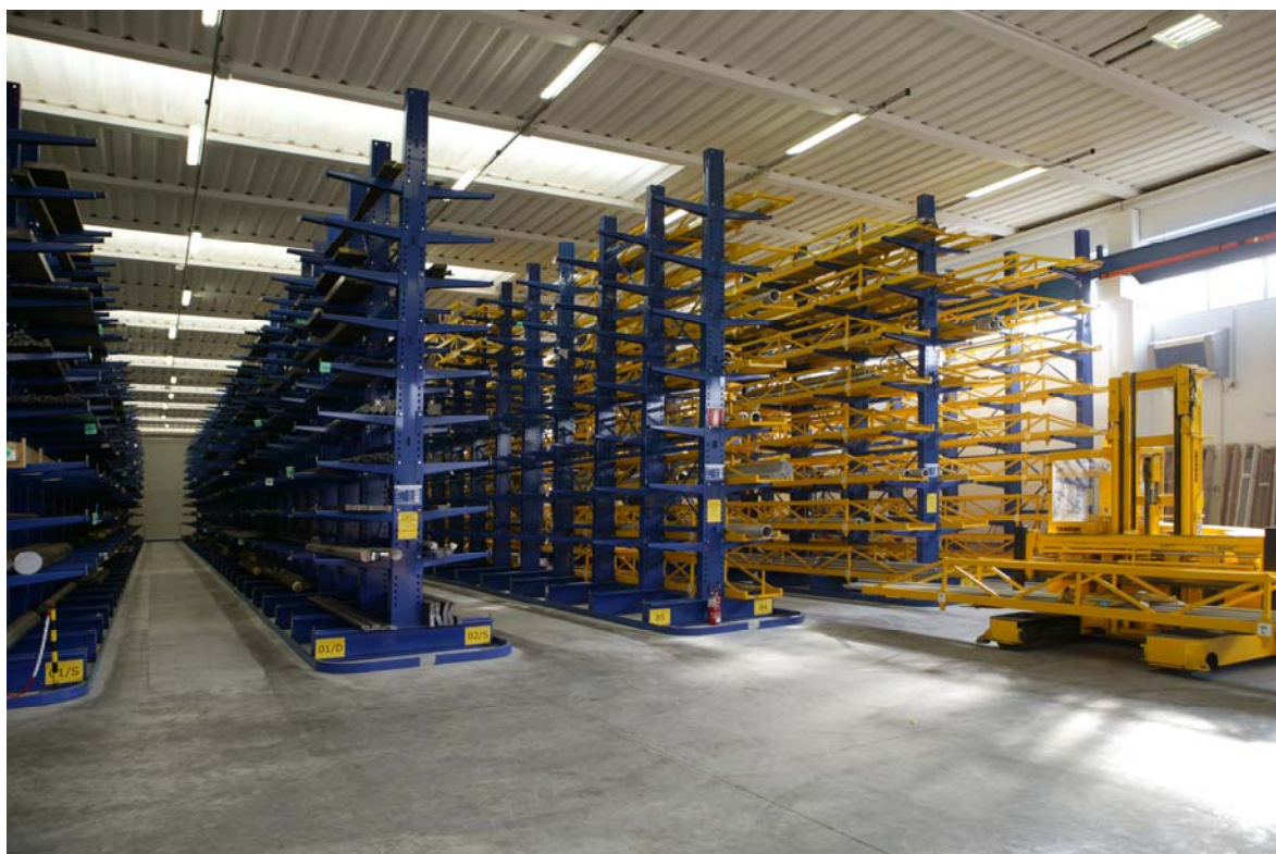
Veduta di parte dei cantilever per lo stoccaggio del materiale
