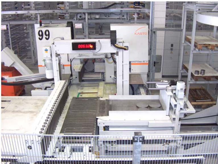
Vista della segatrice e del sistema di pesatura
