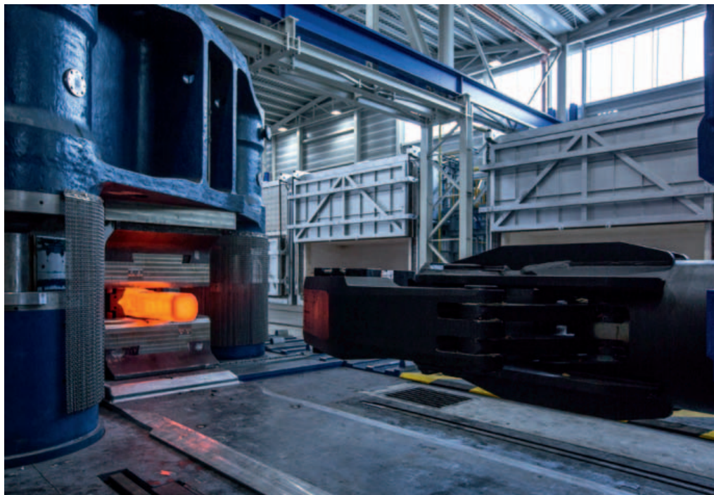
Linea di forgiatura con pressa ad alta velocità P44 da 4.400 t.
